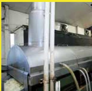
揚げ油は米油とパーム油を使用しています。季節によっておいしさが引き立つ割合を調整しています。直火炊き連続チップフライヤーでじゃがいもを揚げていきます。
