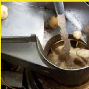
皮をむいたじゃがいもをスライスします。右側の丸い機械の中の刃が高速に回転しじゃがいもを薄くカットします。
