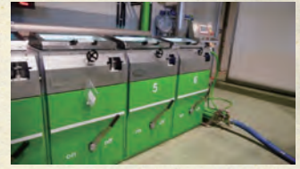
冷却機能が付いた低温圧搾機
